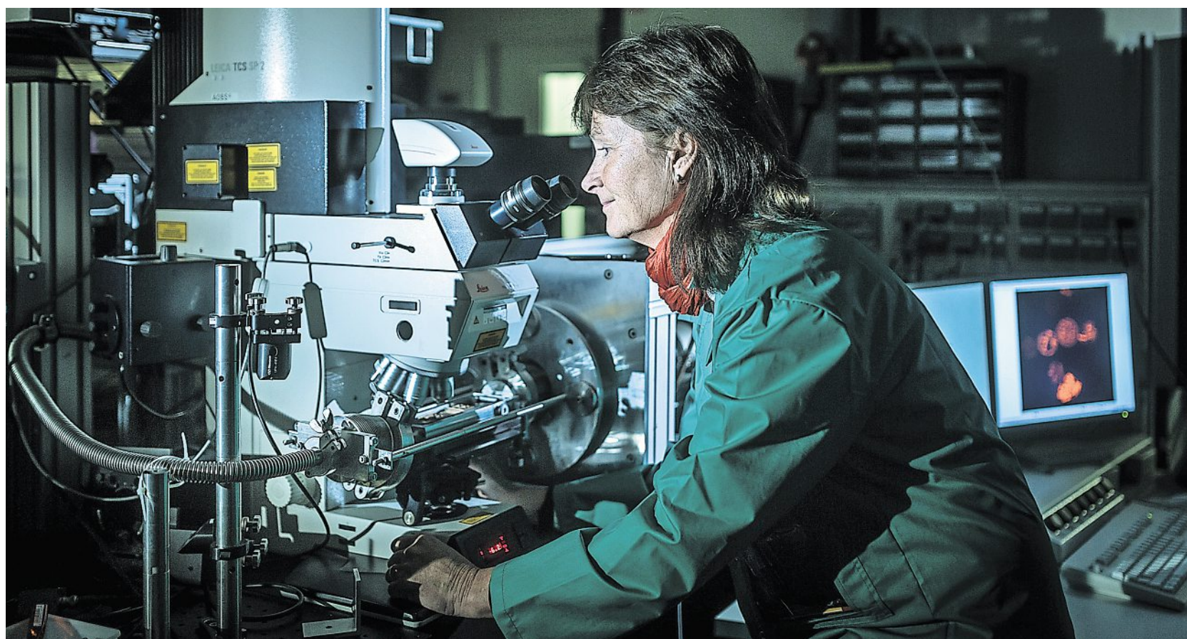
Mithilfe eines Laser-Mikroskops macht Geochemikerin Evelyn Krawczyk-Bärsch am Institut für Ressourcenökologie des Helmholtz-Zentrums Dresden-Rossendorf die Bestandteile der Biofilme sichtbar.
